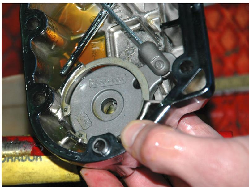
In dem Getriebedeckel befindet sich jetzt die Original Druckplatte, die dann gegen die Clutchlite-Druckplatte ausgetauscht werden soll.
