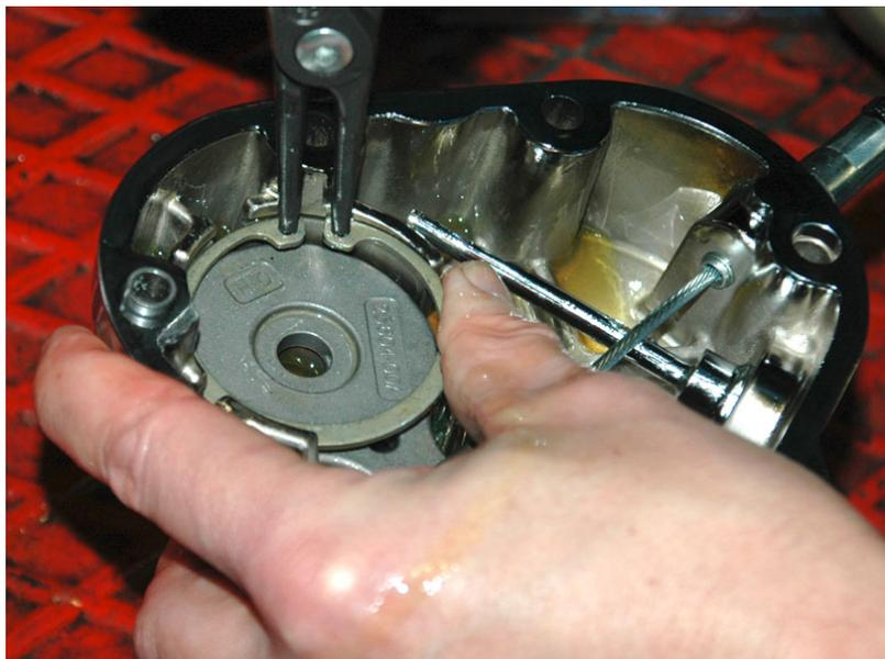
Den Sicherungsring wieder vorsichtig mit der Zange zusammendrücken und in die Nut des Getriebedeckels einlegen (gegebenenfalls hierbei vorsichtig mit dem Daumen fixieren wie im Bild gezeigt). Anschliessend wieder nach links in die Original-Position drehen.
